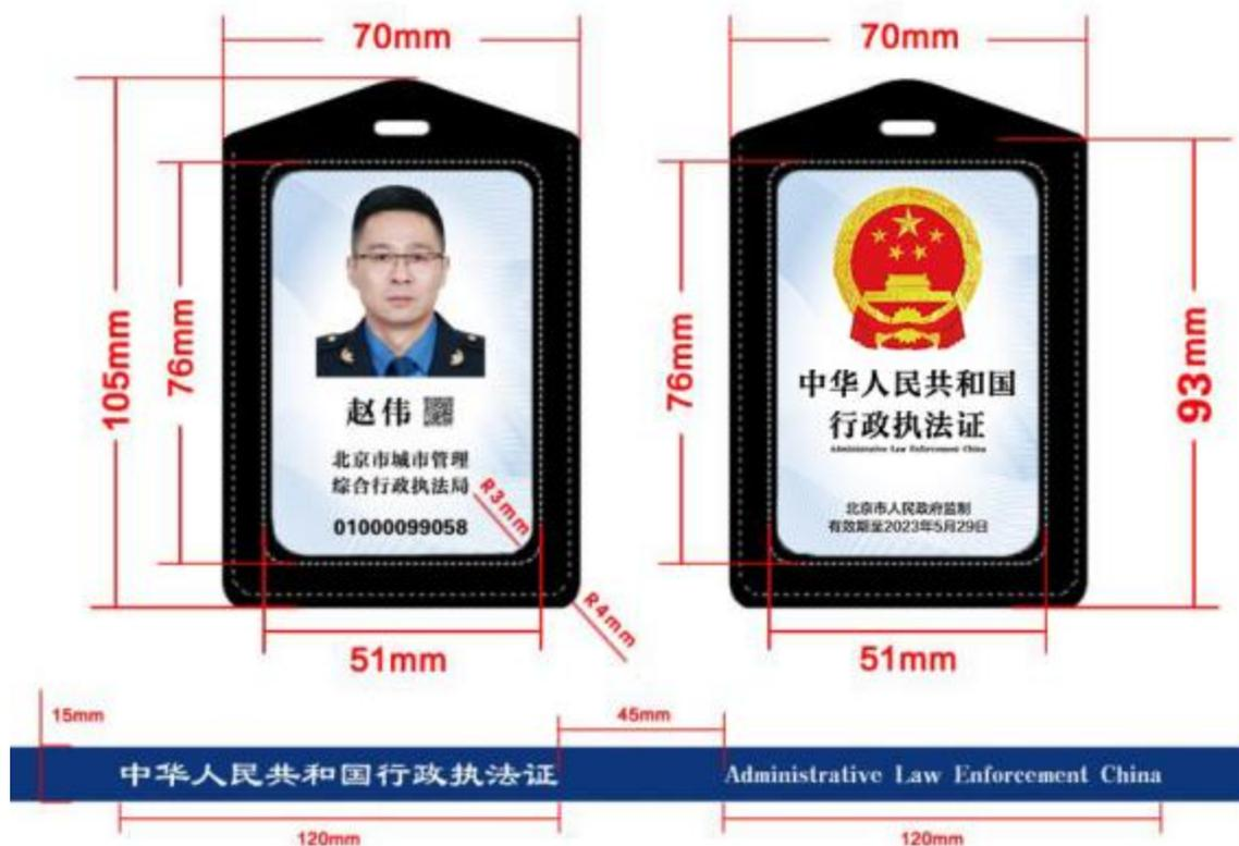
图 3：佩戴式卡套各要素坐标及尺寸
