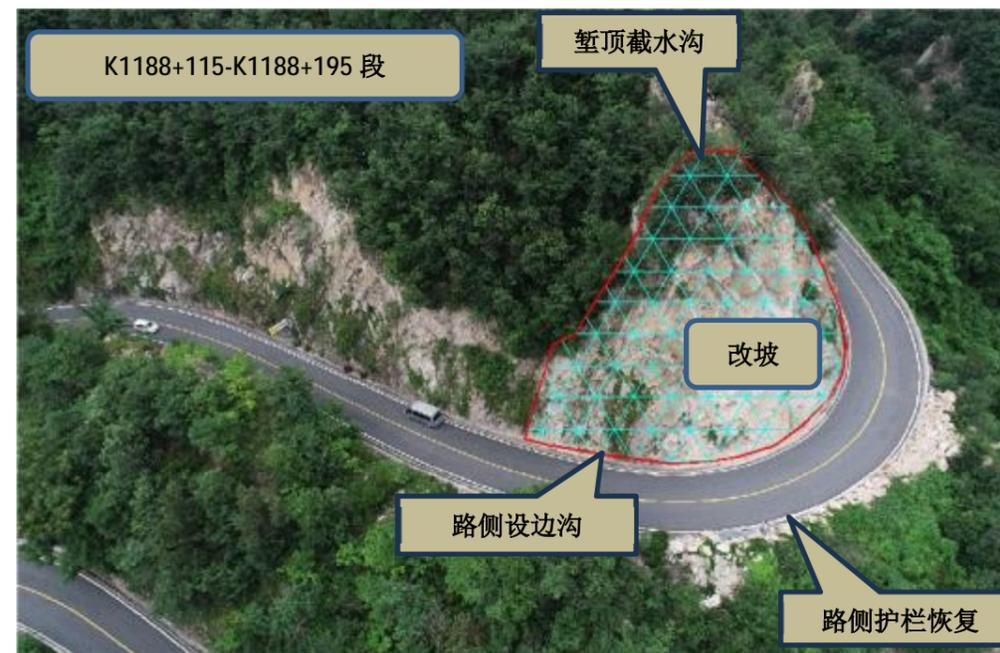
图 4-9 K1188+115-K1188+195 段拟处治方案示意图
