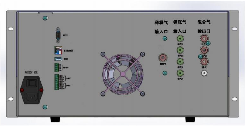
图 2-2 AQ7070 动态校准仪背部接口示意图
