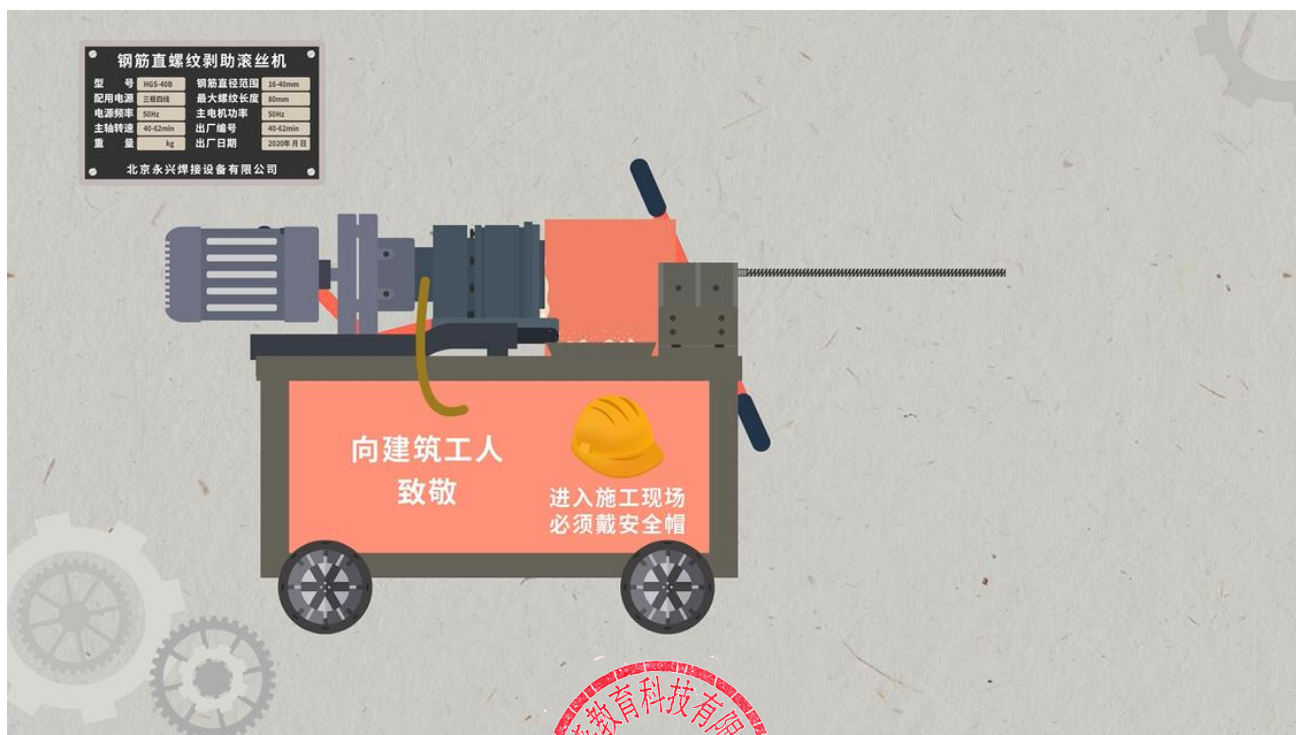
图-《钢筋端螺纹加工》
