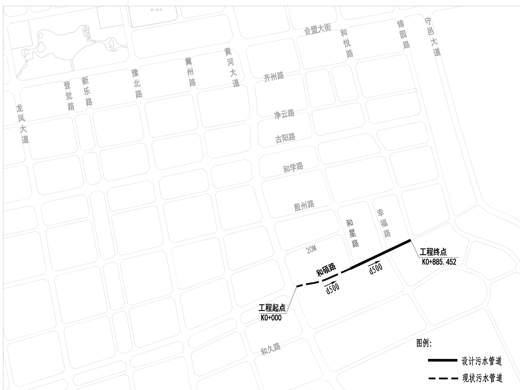
污水管道系统图
